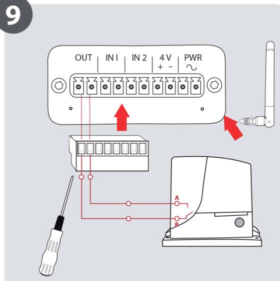
Zapojte signálový kabel (minimálně 2x 0,35 mm<sup>2</sup> Cu) na svorky OUT GSM Klíče a svorky START Vašeho pohonu brány.
