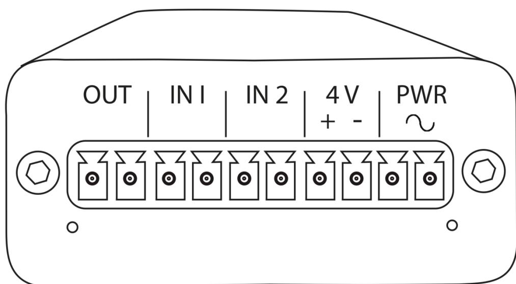
OUT: svorky pro připojení ovládaného zařízení (brána, vrata, závora, ...) s LED signalizací
