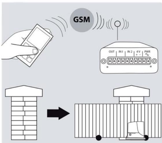
**GSM Klíč LITE 3** je aplikace sloužící k ovládání elektrických pohonů brán, závor a vrat mobilním telefonem. Otevření a zavírání je ZDARMA a je uskutečněno tzv. prozvoněním telefonního čísla SIM karty umístěné v zařízení.
